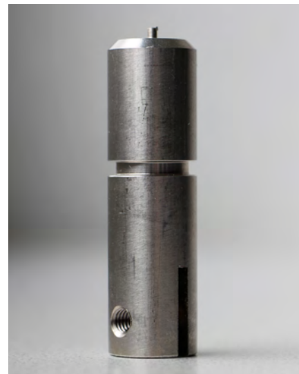
Auch solche Bolzen für Absperrklappen werden in der Metallbearbeitung der Delme-Werkstätten für die KMH-KAMMANN METALLBAU GMBH gefertigt.
